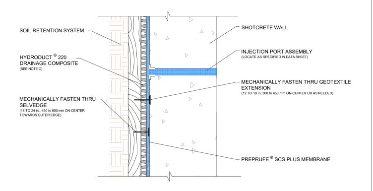
NOTES: A) DO NOT POSITION INJECTION PORT ASSEMBLY DIRECTLY OVER THE SIDE LAP
