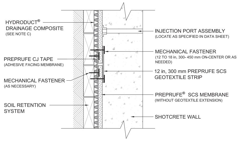
NOTES: A) USE SEAM ROLLER TO ENSURE PROPER SEAL TO THE INVERTED PREPRUFE CJ TAPE
